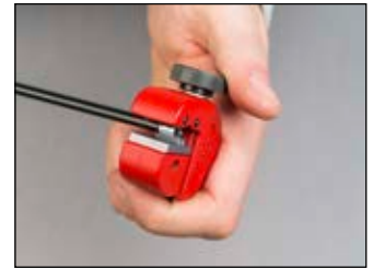
Positionierung der Leitung um Ummantelung abzuschaben
