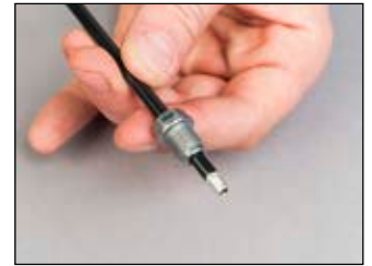
Aufstecken der Überwurfmutter
